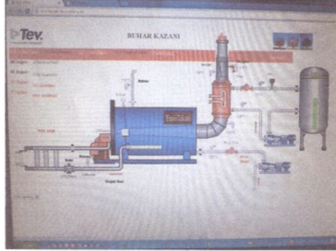
Şekil 3. TEV-MAG01 SCADA PC İzleme Ekranı
